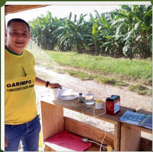
**1** Materiais que você irá precisar para fazer a limpeza e reativação do mercúrio: uma bateria de 12v, sal, um pote de vidro, água, fios de cobre, grafite e papel absorvente.
