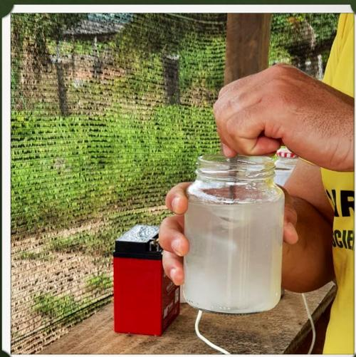
**2** Prenda a ponta de cada fio de cobre descascado em cada um dos polos da bateria. Coloque água no pote de vidro e acrescente sal, na proporção de 10% do peso do mercúrio. Se for limpar 1kg de mercúrio, use 100g de sal. Misture bem.
