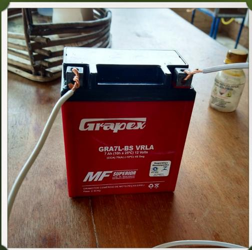
**4** Prenda a ponta de cada fio de cobre descascado em cada um dos polos da bateria.
