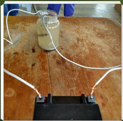
**7** Coloque o grafite enrolado no fio dentro do recipiente. **Atenção! Não deixe o grafite encostar no mercúrio! Os fios não podem encostar um no outro!**
