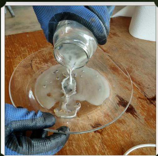
**9** Retire os fios do recipiente, e despeje o máximo que puder da água do pote. Em seguida, despeje o mercúrio em um prato fundo de vidro.
