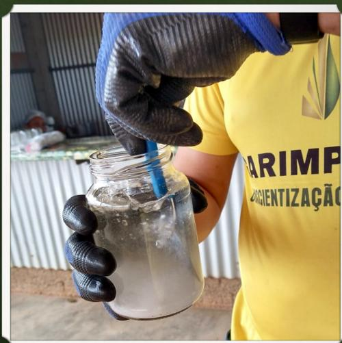
**2** Coloque água no pote de vidro e acrescente sal, na proporção de 10% do peso do mercúrio. Se for limpar 1kg de mercúrio, use 100g de sal. Misture bem.
